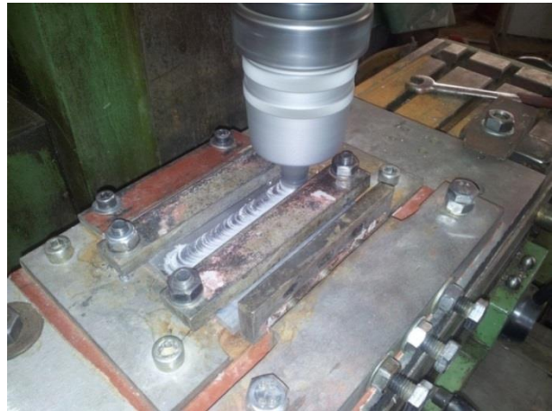
شكل (4): تثبيت الألواح وعملية لحام الخلط الاحتكاكي
