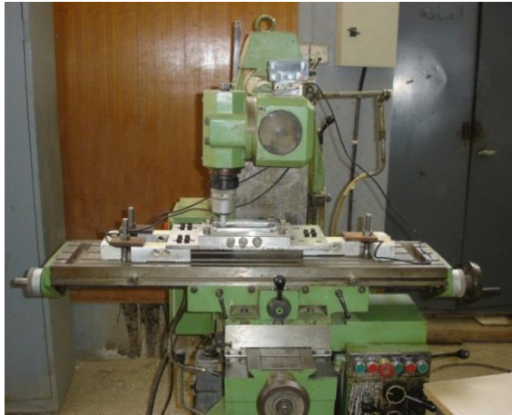
شكل (3): ماكينة تفرير نوع (GATE) المستخدمة في لحام الخلط الاحتكاكي
